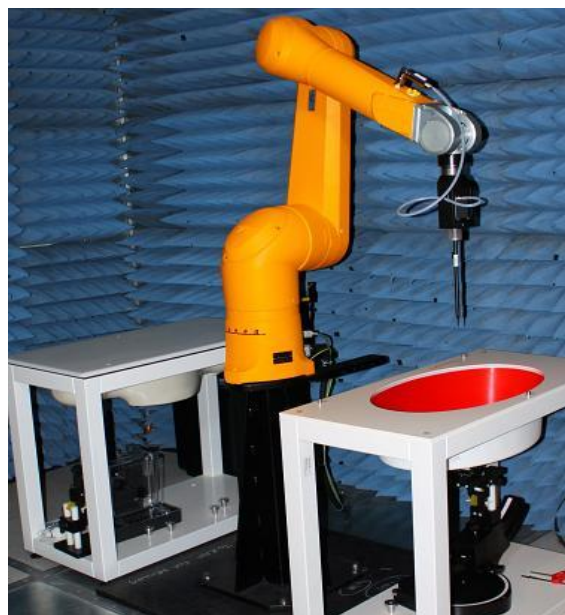
ตัวอย่างระบบและตรวจวัดค่า Specific Absorption Rate (SAR)
