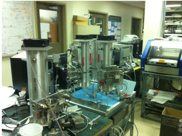
ระบบศึกษาวิจัยผลกระทบจากการได้รับคลื่นแม่เหล็กไฟฟ้าในหนูทดลอง
